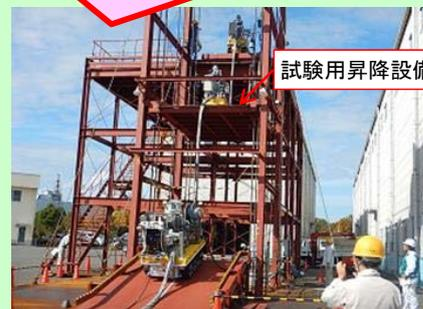
上部階用除染装置(試験風景)
