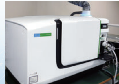
マルチ四重極ICP-MS (PerkinElmer NexION 5000) Multi-quadrupole ICP-MS
