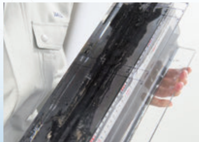
原子炉内部の構造物を高温で溶かした試験体 High temperature melted specimen in reactor core component
