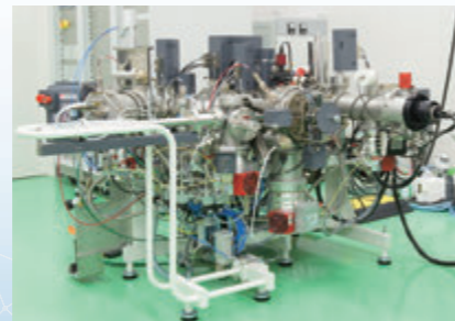
二重収束型二次イオン質量分析装置(CAMECA IMS 7f-Auto) Dynamic Secondary Ion Mass Spectrometer
