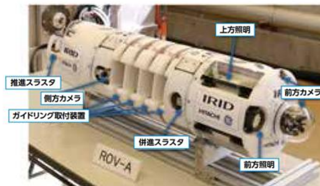
原子炉格納容器内部詳細調査用潜水機能付ポート(ROV-A)
