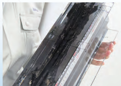
原子炉内部の構成物を高温で溶かした試験体 High temperature melted specimen in reactor core component
