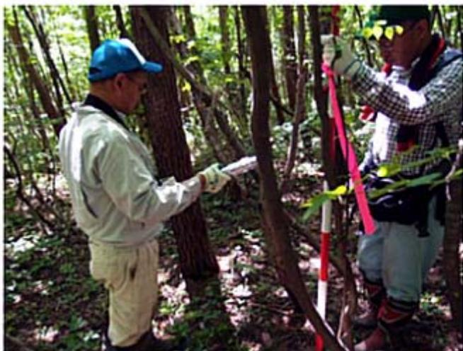
写真6 空間線量率の測定
