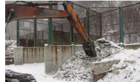
①重機による試料の攪拌
