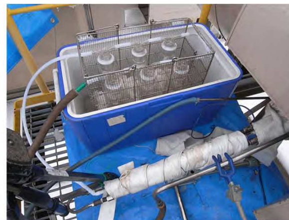
排ガス採取用の試料採取器具 (JIS Z8808規定Ⅱ型)
