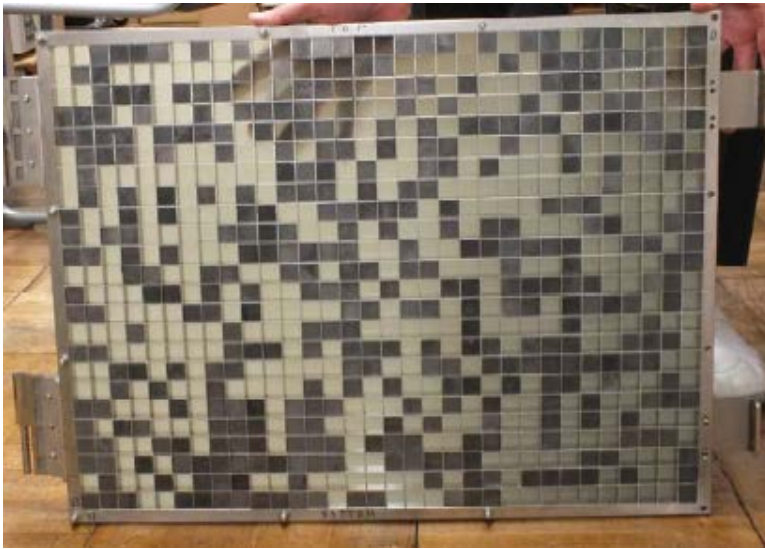
実際のコーデッドマスク 鉛と空隙が50%ずつのランダム配置
