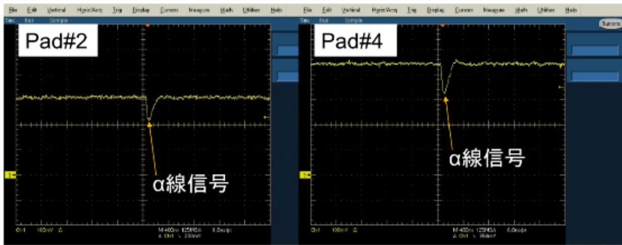
α線の明瞭な応答波形を確認し、信号処理集積回路とダイヤモンドpinダイオードとの接続動作を実証
